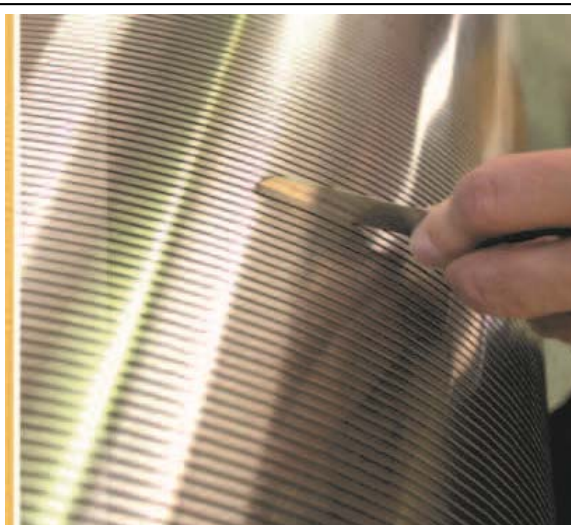
Fig. 7.20. Operațiunea de verificare a integrității filtrelor înainte lansării în gaura de sondă
