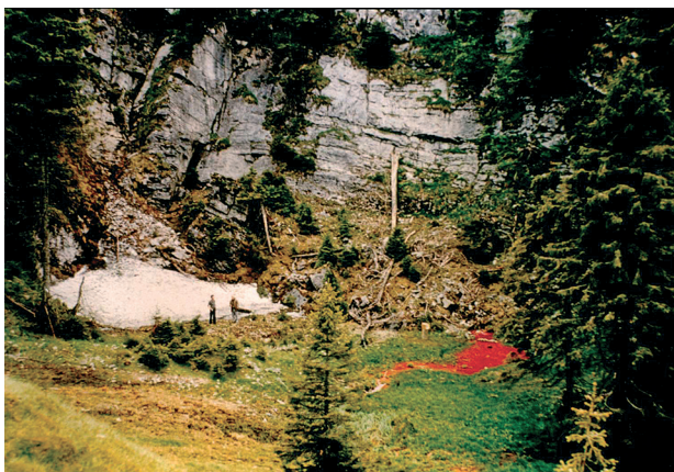
Foto 3.7. Marcarea cu rodamină a apei ponorului din Vărășoia în luna iunie 1985.
